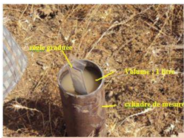
Fig. 3. Test d'infiltration au monocylindre
